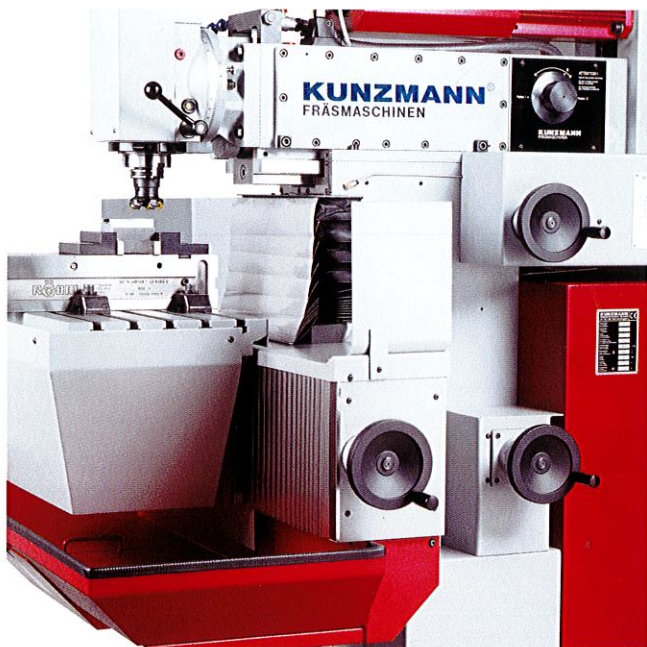
Ergonomisch angeordnete Sicherheitshandräder zum manuellen Verfahren
