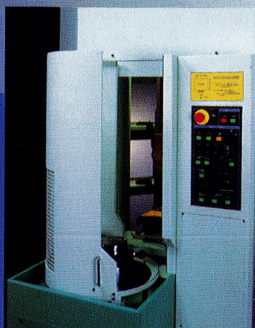
Drehbare Ladestation zur einfachen Bedienung
