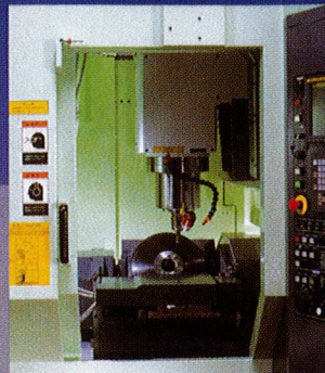
Breite Arbeitsraumtür, voll verriegelt
