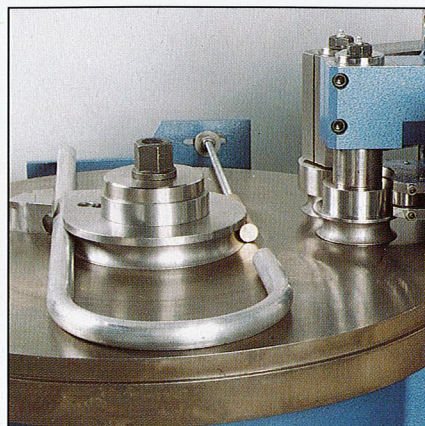
Biegen von Rohren.
