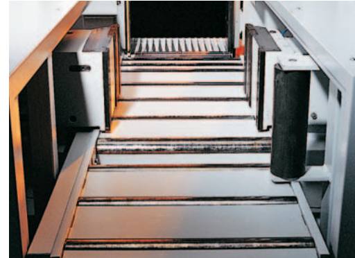
Die durchgehende integrierte Maschinenrollenbahn vereinfacht das Materialhandling und den Transport kurzer Reststücke.
