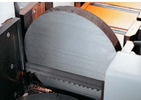
Weniger Schrott, mehr Gewinn: Minimale Reststücklänge 35 mm, 50 mm bei KASTOtec A 7, im Automatikbetrieb.
