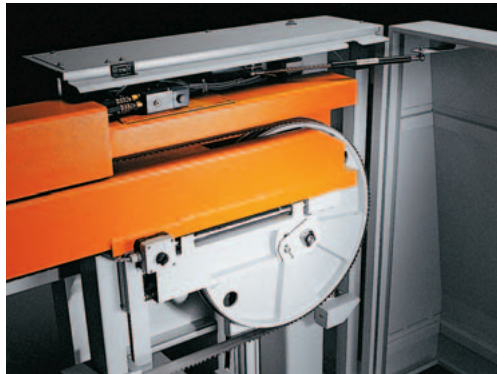
Schneller Bandwechsel direkt von vorne: dank guter Zugänglichkeit in wenigen Minuten erledigt.
