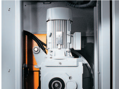
Stark und feinfühlig: frequenz geregelter Kegelstirnmotor direkt am zentrisch gelagerten Antriebs-Laufrad.
