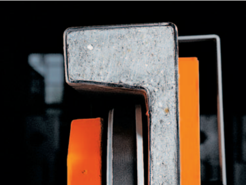
Moderner Werkzeugmaschinenbau: mit Mineralguss ausgegossener Stahlmantel des Oberbaus der KASTOtec.
