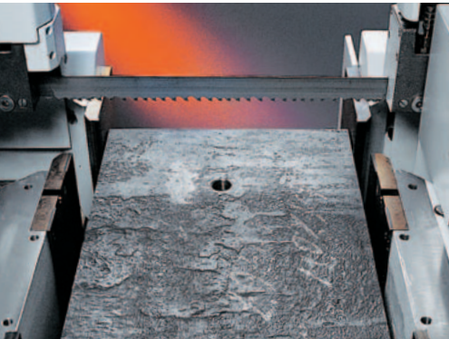
Automatischer Freihub des festen Spannbackens um ca. 10 mm während der Materialtransportbewegung.
