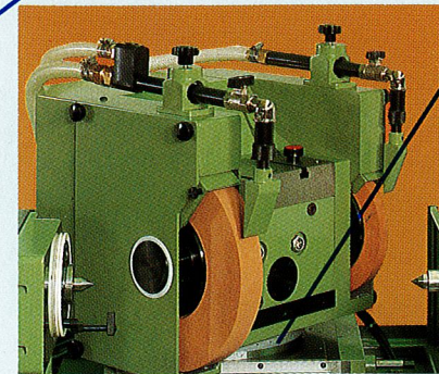
Kontrolle der Drehbewegung des Schleifspindelstockes (F-Achse), von besonderer Wichtigkeit bei der Fertigung von
