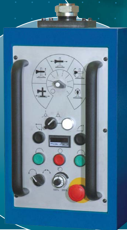
Bedientafel: übersichtlicher, selbsterklärender Aufbau der Bedienelemente
