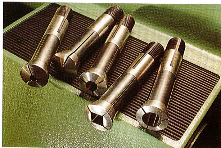
Spannzangen. Schaft- \phi 20 mm, Bohrungen von 0,5 bis 17,5 mm, jeweils um 0,5 mm steigend, und Vierkantaufnahmen mit 4, 6, 8, 10 und 12 mm.
