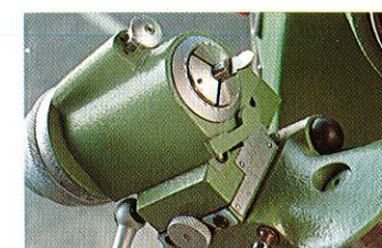
Der Werkzeugschlitten ist in Querrichtung beidseitig verstellbar.
