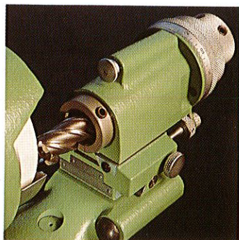
Fräser-Sonderaufnahme. Für Spann- \phi 16, 18, 20, 25 mm und Morsekegel MK1, MK2, MK3.
