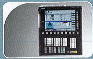
SIEMENS 840 D controller
